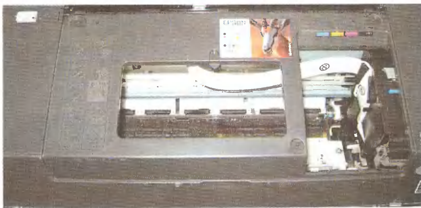
Epson C91 с поднятой крышкой – в нерабочем состоянии печатающая головка прячется от пользователя. Слева от наклейки Epson находится стрелка, которая будет указывать на закончившийся картридж.
